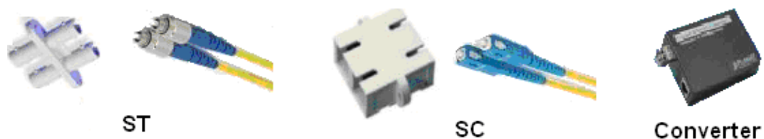
Hình 3. 14 - Một số đầu nối cáp quang và converter
