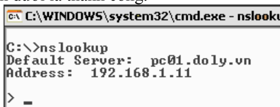
Hình 7. 38 - Kiểm tra phân giải tên ra IP
