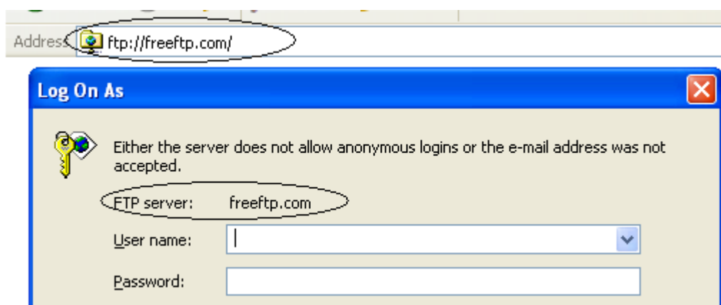
Hình 2. 1 - Kết nối vào FTP server dùng giao thức FTP
